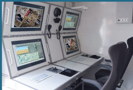
НПУ на базе автомобиля типа МАЗ с кузовной надстройкой, системой жизнеобеспечения экипажа и прицепом для транспортировки БЛА
