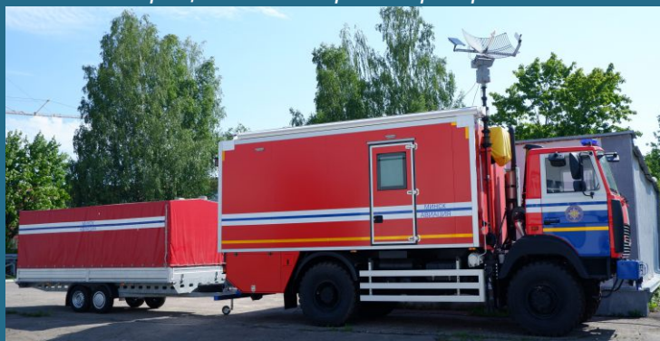
НПУ на базе автомобиля типа МАЗ с кузовной надстройкой, системой жизнеобеспечения экипажа и прицепом для транспортировки БЛА
